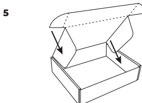
5 Согните «ушки» и борта в крышки конструкции для закрытия коробки
